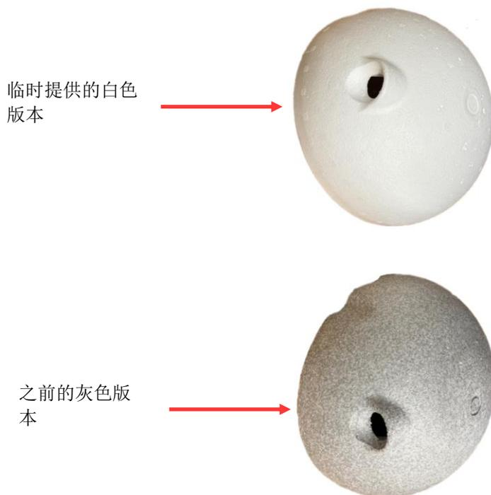
图 1 - 端盖隔热件对比
