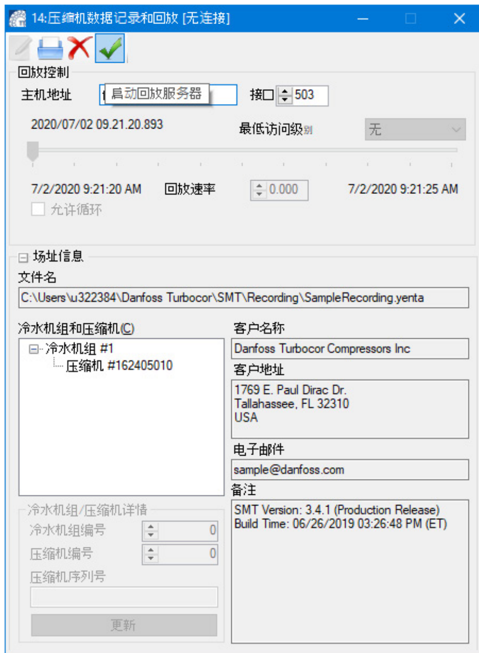
图 2-7 显示出启动回放服务器的“压缩机数据录像和回放”工具
