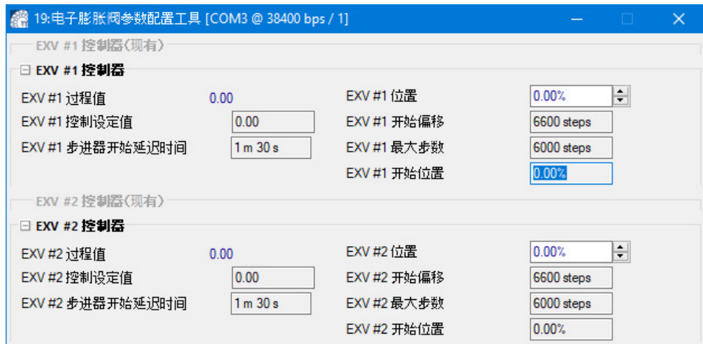
图 11-3 “电子膨胀阀参数配置工具”(适用于 4.x 版软件)
