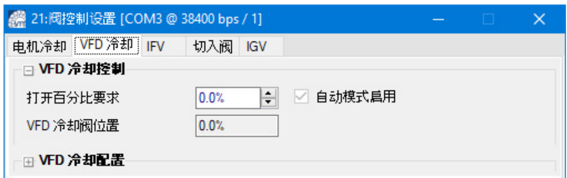
图 14-13 阀门控制设置 - VFD 冷却
