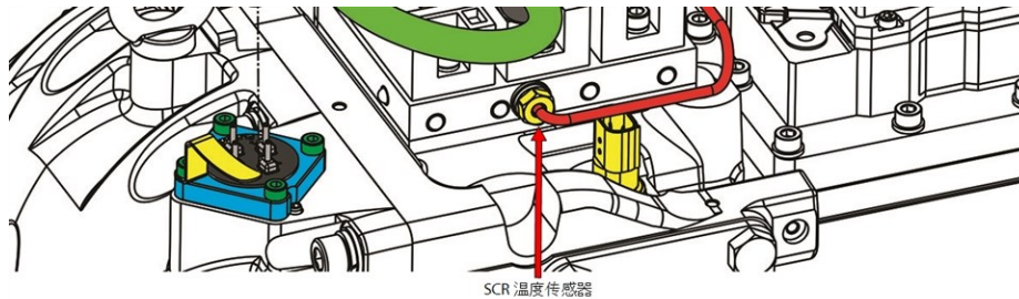
图 4-147 SCR 温度传感器位置 - TTS300/TGS230
